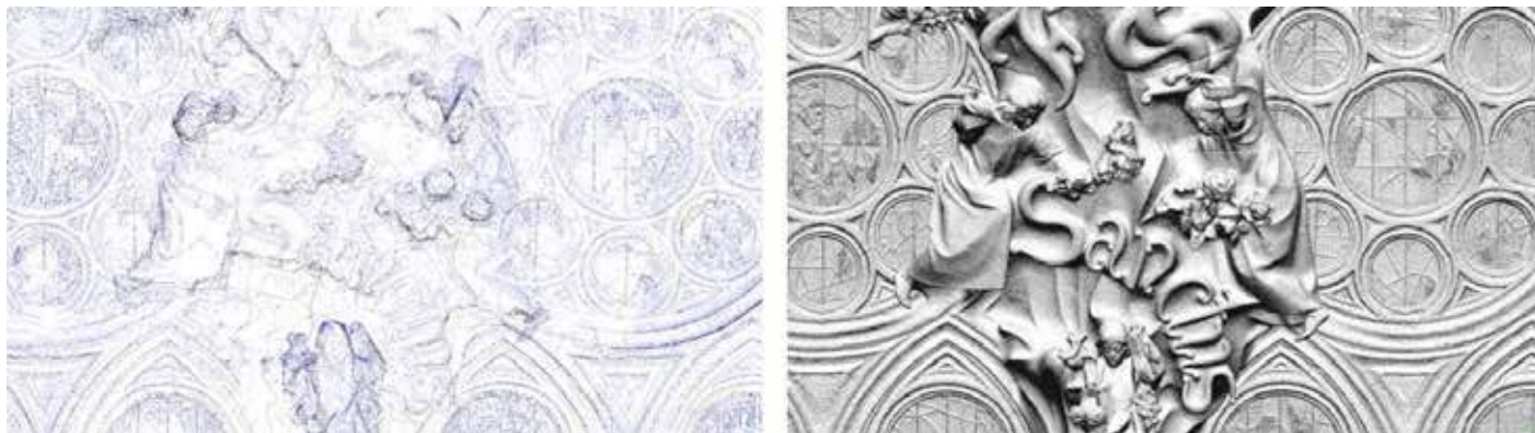
Ilustración 4. Filtrado de continuidad de la superficie. Izquierda ruido, derecha modelo de nube de puntos final
