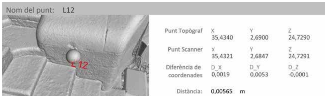
Ilustración 12. Control de calidad mediante la detección de esferas y levantamiento topográfico
